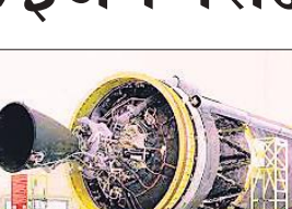
इसरो के प्रोपल्शन कॉम्प्लेक्स में सीई-20 इंजन का परीक्षण
